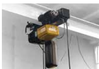
elektryczne wciągniki łańcuchowe GIS
